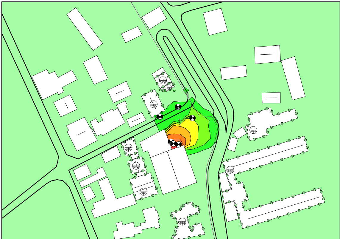
Propagation du bruit de l'extracteur dans le quartier après traitement acoustique
